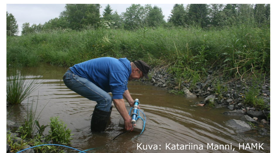
Kuva: Katarina Manni, HAMK Vedenlaatumittarin asennus käynnissä. Kuvassa Lauri Arvola Helsingin yliopistosta.
