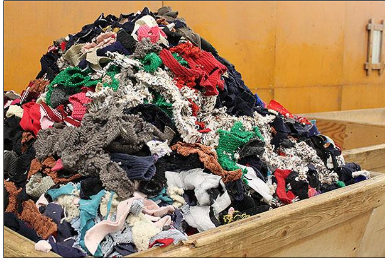
Kuva 11. Mekaanisesti rouhittua tekstiilijäätettä, Dafecor Oy
